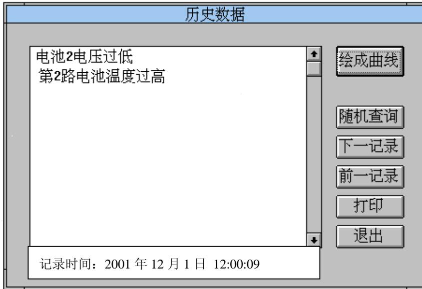
点击“绘成曲线”，根据设定的起始时间和时长，可将历史数据绘成曲线，以下是电池充放电曲线显示界面：
