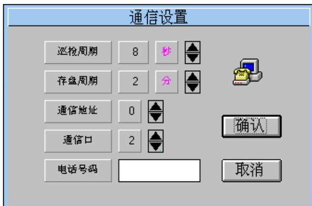
“通信设置”窗口中包含：巡检周期、存盘周期、通信地址、通信口、电话号码（MODEM 方式用）。
