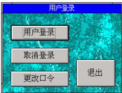
按下“用户登录”按钮后出现口令输入窗口，输入正确的口令并按确认按钮，主画面的“启动系统”按钮变为有效。在“启动系统”按钮有效时按下此按钮，监控软件开始向电池监测仪发送取数据命令。
